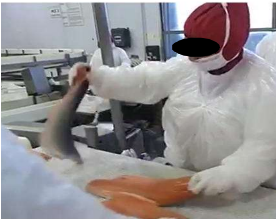
Información de la foto: Con pinza de mano derecha y movimiento rápido de la extremidad superior derecha levanta el filete, para asegurarse de que esté en buenas condiciones para ser empacado. En 10 segundos, inspecciona 3 salmones aproximadamente.
